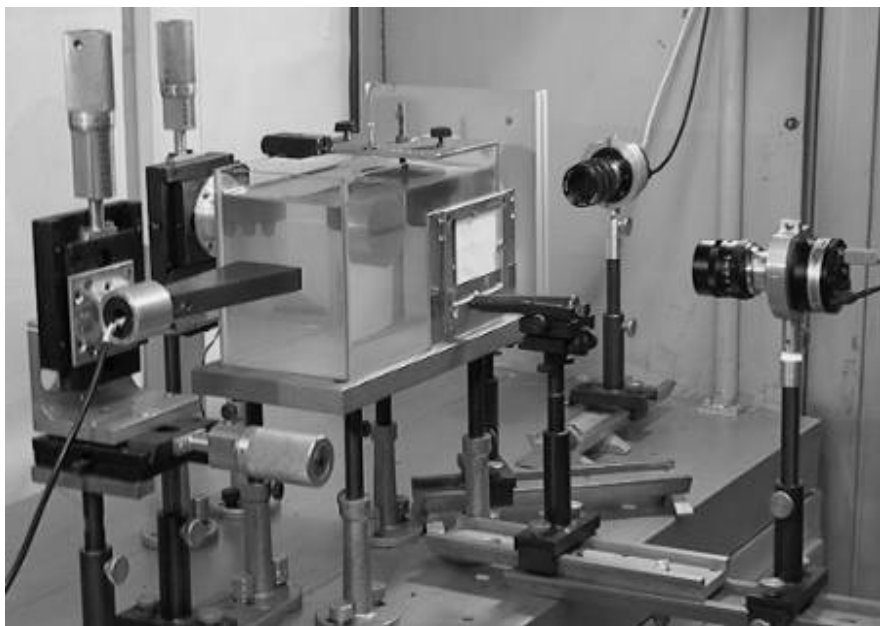
Рис. 3. Внешний вид двухракурсной рефрактографической системы
